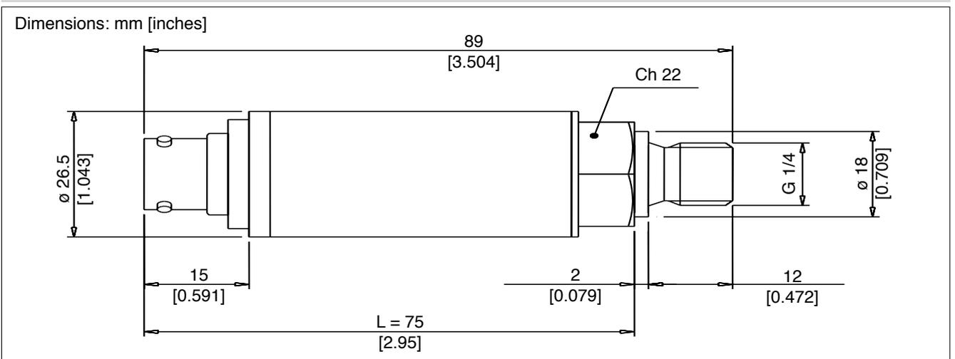
**Dimensions:** TPSADA, via la carte d'autozéro et gain, est 5 mm (0,197 in) plus longue ; sur la fiche technique de série de la TPSA, la dimension "L" devient donc 75 mm (2,95 in)..
