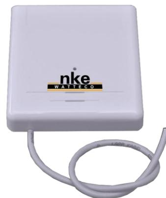
Le capteur PULSE S0 permet de téléreléver les données de comptage provenant de la sortie impulsionnelle des compteurs d'eau, de gaz, d'électricité ou thermique. Il transforme les compteurs existants en compteurs communicants via un réseau public ou privé LoRaWAN™.
