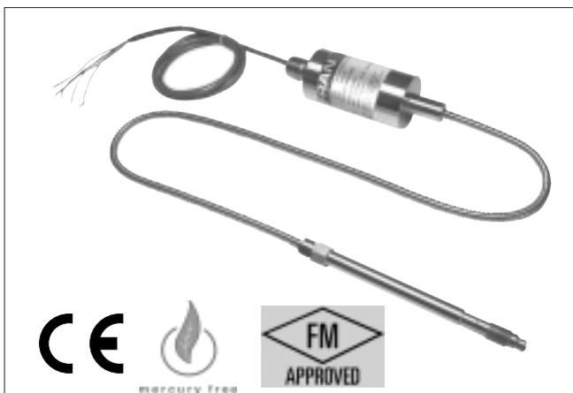
Le groupe amplificateur/capteur d'un transmetteur de pression de melt de la série WF est livré dans un boîtier en acier inoxydable soudé, avec un câble auxiliaire conduit. Ce boîtier métallique est parfaitement étanche aux agents atmosphériques et répond aux exigences pour les zones dangereuses.
