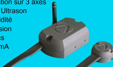
**La balise analyse la machine en auto-apprentissage, puis surveille et alerte**
