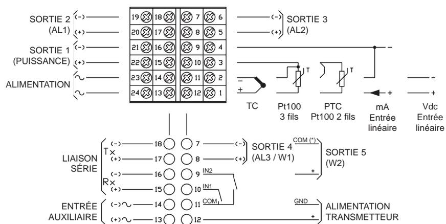
(\*) COM est connecté à la borne 7 si la sortie 4 est continue (W1)
